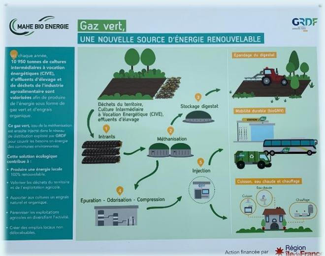
Les cultures spécifiques (maïs, luzerne) alimentent les silos avec les lisiers de l'étable. La matière utile est épurée, odorisée et compressée pour être utilisée sous forme de gaz. Les déchets (digestats) sont employés pour fertiliser le sol.
